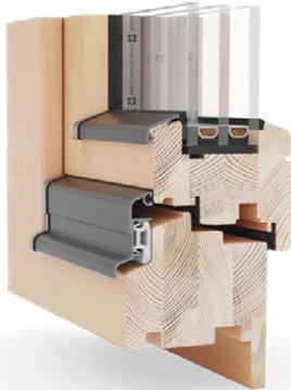
Une version du profil qui permet d'installer de nouvelles fenêtres dans des bâtiments existants sans avoir à démonter les anciens dormants en bois. Possibilité d'utiliser une ailette de rénovation de 20 à 80 mm pour recouvrir l'ancien cadre à l'intérieur du bâtiment.
