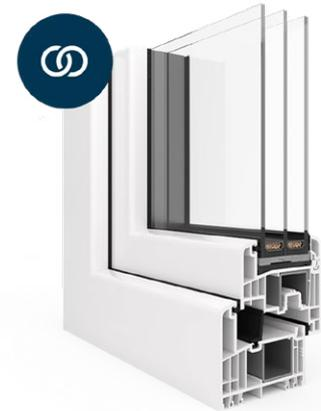
La technologie de collage de vitrage à sec. Le choix de cette solution permet d'augmenter la taille maximale de la fenêtre, tout en assurant un montage et un démontage faciles du vitrage utilisé.
