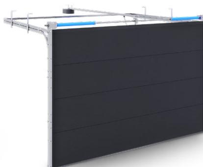
L'emplacement des ressorts de torsion à l'avant permet de réaliser les portes les plus grandes, nécessitant une hauteur libre minimale de 200 mm. Les ressorts de torsion sont prévus pour 25 000 cycles. Le système INFINITI F permet un poids de porte allant jusqu'à 290 kg.
