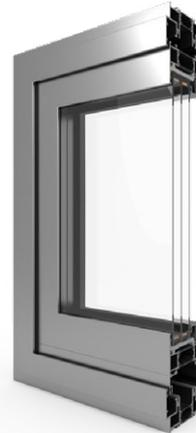
Les portes basées sur le système de portes et fenêtres Decalu 88 sont équipées d'une rupture de pont thermique afin de réduire l'effet bimétallique et de les protéger contre la déformation. Dans ce cas, de très grands vitrages ou des panneaux de remplissage peuvent être incorporés dans le cadre.
