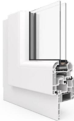
Profilé qui permet d'installer des fenêtres dans des bâtiments existants sans avoir à retirer les anciens cadres. L'aile de recouvrement recouvre l'ancien cadre à l'intérieur du bâtiment, et des profilés supplémentaires spéciaux le masquent à l'extérieur.
