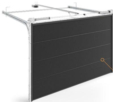
INFINITI Thermo F i R – Les panneaux ont une épaisseur de 60 mm et présentent l'un des meilleurs coefficients thermiques du marché. Avec les joints à double lèvre qui forment la chambre thermique, ils assurent une isolation thermique efficace. Les ressorts de compensation de poids de la porte sont calculés pour 25 000 cycles de fonctionnement sans problème.
