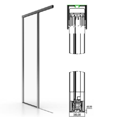
La moustiquaire latérale Jolly a été conçue pour les fenêtres et les portes de terrasse. Avec son rail discret au sol, sa poignée ergonomique et ses ressorts pour une rétraction facile, elle s'intègre parfaitement dans les intérieurs élégants. Elle convient également aux fenêtres et aux portes fréquemment utilisées. L'utilisation de rouleaux permet une meilleure transparence du filet que dans les modèles plissés. Protection et subtilité vont avec une simplicité d'utilisation.
