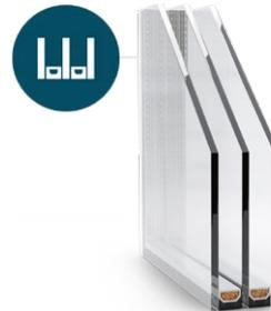
Dans les solutions à haut rendement énergétique, l'utilisation de triples vitrages, également connus sous le nom de doubles vitrages, est standard. La combinaison de cadres chauds, de gaz noble dans les chambres et de revêtements thermiques couvrant les faces intérieures des feuilles permet d'obtenir un coefficient de transfert de chaleur  $U_g$  très faible.
