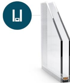
Les doubles vitrages sont utilisés lorsque l'isolation thermique n'est pas une priorité. Ils se composent de deux feuilles de verre séparées par un espaceur et une chambre à gaz, généralement remplie d'un gaz noble pour améliorer les propriétés thermiques de l'unité.
