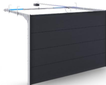
Le positionnement des ressorts sur la poutre arrière permet d'installer des portes de grandes dimensions avec seulement 120 mm de hauteur libre. Les ressorts de torsion sont prévus pour 25 000 cycles. Le système INFINITI R permet un poids de porte allant jusqu'à 165 kg.
