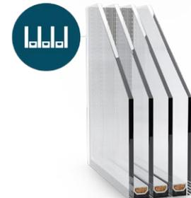
Les ensembles à trois chambres (quatre vitres) ne sont utilisés que lorsque l'isolation thermique est une priorité absolue. Ils permettent d'obtenir les meilleurs paramètres thermiques au détriment des apports solaires, dont l'amélioration nécessite l'utilisation de solutions complémentaires. L'utilisation du paquet n'est possible que dans des systèmes sélectionnés.
